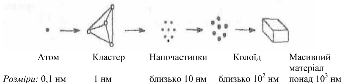
Рисунок 2.2 – Основні етапи формування блочного матеріалу з атомів [5]
